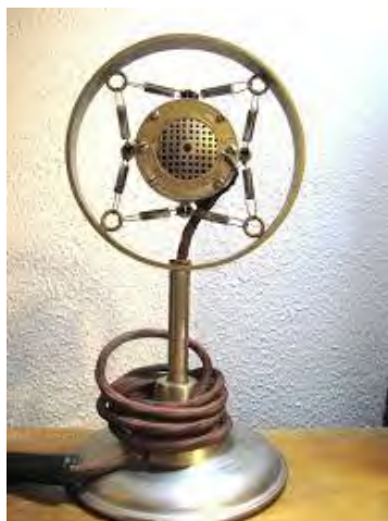
Apparecchio radio Philips con valvole in bakelite (1930) - Microfono radiofonico a carbone (1920), con molle isolanti da possibili vibrazioni del tavolo o del pavimento (Museum of Science and Industry – Chicago)
