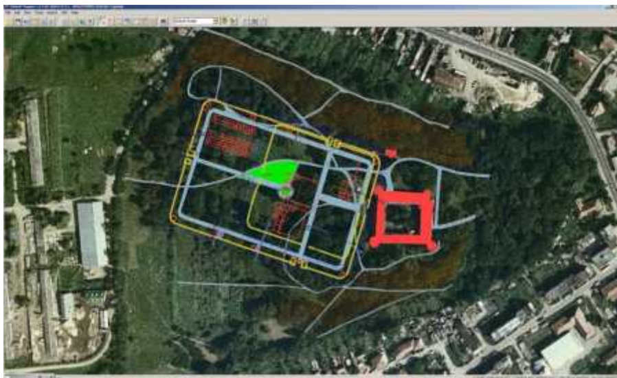
Fig. 8 - Vectorii din faza ultimă de prelucrare sunt suprauși pe ortofotoplan pentru verificarea finală. C. Rezultatele Concrete 93
